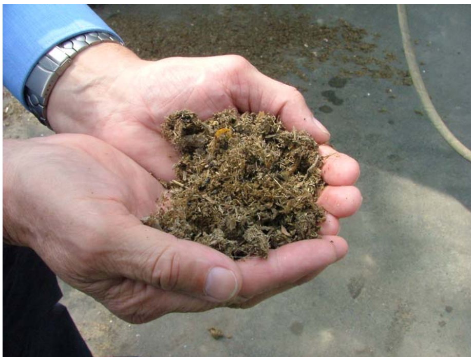
Obr. 5.6: Odvodněný kal po anaerobní fermentaci BRKO, bioplynová stanice Alteno, SRN
