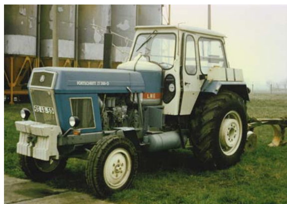
Obr. 3.8: Traktor ZT 300 s kryogenní nádrží kapalného metanu před kabinou
