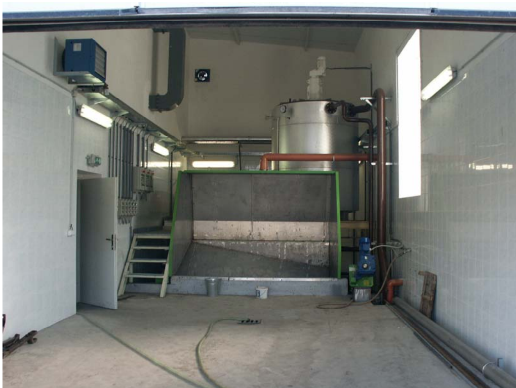
Obr. 5.2: Bioplynová stanice Kněžice, příjem zpracovávaného materiálu, linka na termickou stabilizaci a rozměrovou úpravu substrátu
