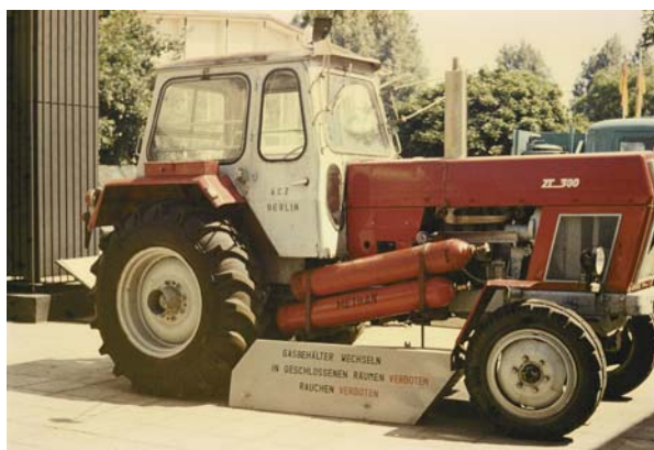
Obr. 3.7: Traktor ZT 300 s připevněnými tlakovými lahvemi na boku
